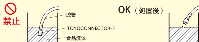
13. **⚠️ 警告** 请勿在胶管扭曲的状态下进行配管或使用。胶管扭曲时，其内部结构会发生变形，从而导致胶管“破裂”，引发危险。请参考以下示例，采取适当的处理措施。
