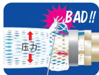
胶管膨胀引起脱丝爆裂
