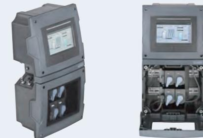
8905型在线分析系统是紧凑模块化的系统，是多通道多功能单元，可用于Burkert EDIP 平台的传感器和电子模块。用于持续分析重要的水参数 - pH 值 - 氯/二氧化氯 - 导电率 - ORP - 浊度 - 温度等。模块化的结构允许检测系统能根据客户需求，安装、配置、操作轻松简单。传感器即使在维护状态，仍然能持续测量。传感器通过7"触摸屏或Burkert Communicator 控制。
