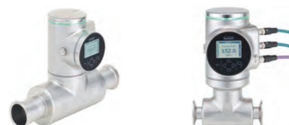
8098 型流量计基于 SAW (Surface Acoustic Waves - 表面声波) 技术，主要用于满足极高卫生级要求的应用。高卫生级标准的实现：- 使用合适的不锈钢材料 - 没有任何与介质接触的测量元件 - 理想的外部卫生接口设计。表面声波流量计 (FLOWave) 集成一系列功能，具有灵活性、可清洁性、结构紧凑性、重量轻、安装和操作简单等优势，此外该设备还符合多项技术标准。在均质、不含空气和固体的液体中可获得最佳测量结果。对于粘度更高的液体，可以使用内置密度补偿。虽然无法测量气体和蒸汽，但是不会影响设备本身。回流后，流量计能自动恢复液体正确测量。
