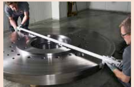
圆弧刃量爪适于精确的内侧测量
