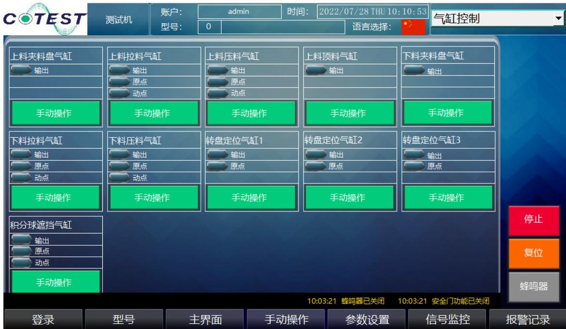
图表 17 手动操作页面-气缸输出
