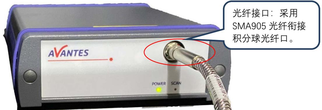
图表 7 光谱仪连接图
